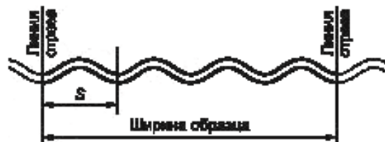
Рисунок 19 — Схема обрезки целых листов перед испытанием
