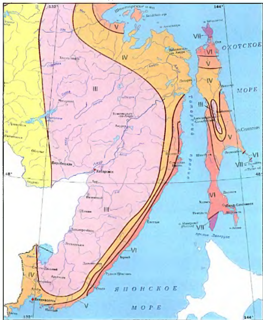
КАРТА 3а. РАЙОНИРОВАНИЕ ТЕРРИТОРИИ ПРИМОРСКОГО КРАЯ И ОСТРОВА САХАЛИН ПО ДАВЛЕНИЮ ВЕТРА
