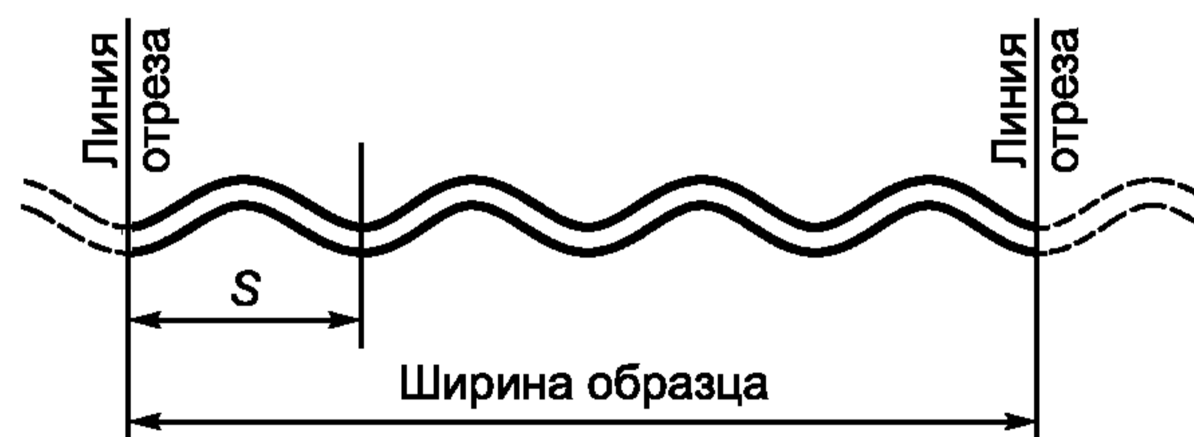
Рисунок 19 — Схема обрезки целых листов перед испытанием
